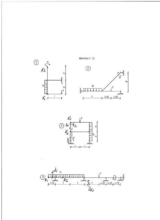
2. Вычислить горизонтальное перемещение точки K от теплового воздействия.
