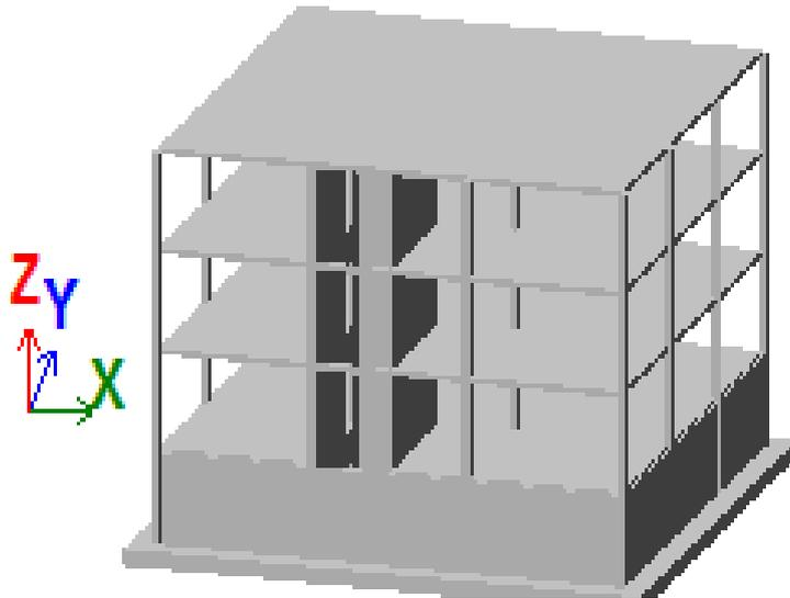
**Задание:** Построить в соответствии с вариантом исходных данных пространственную модель конструктивной системы многоэтажного монолитного здания колонной конструктивной системы с подземной частью и фундаментной плитой, плоскими плитами перекрытия и несущими стенами, поэтажно установленными на перекрытие. В здании предусмотреть лестнично-лифтовую шахту
