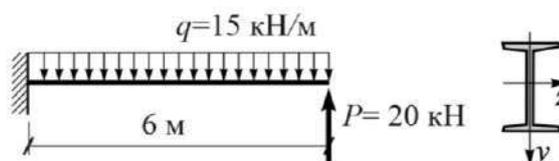
1. Построить эпюры расчетных усилий  $Q$  и  $M$ .
