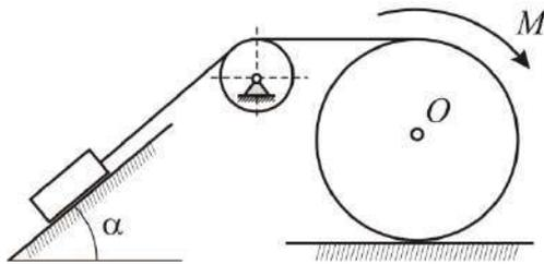
Сплошной однородный цилиндр массы  $m_1 = 4m$  радиуса  $r$  катится по горизонтальной плоскости без скольжения под действием вращающего момента  $M$ , поднимая груз массы  $m$ . Массой блока пренебречь. Коэффициент трения между грузом и наклонной плоскостью равен  $f$ . Определить силу давления блока на ось вращения.
