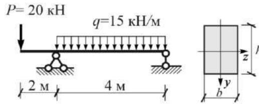
1. Построить эпюры расчетных усилий  $Q$  и  $M$ .
