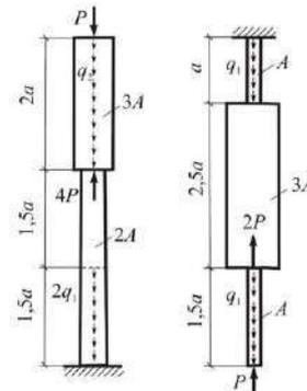
Задача 2. Подбор сечения растянутого стержня статически определимой системы
