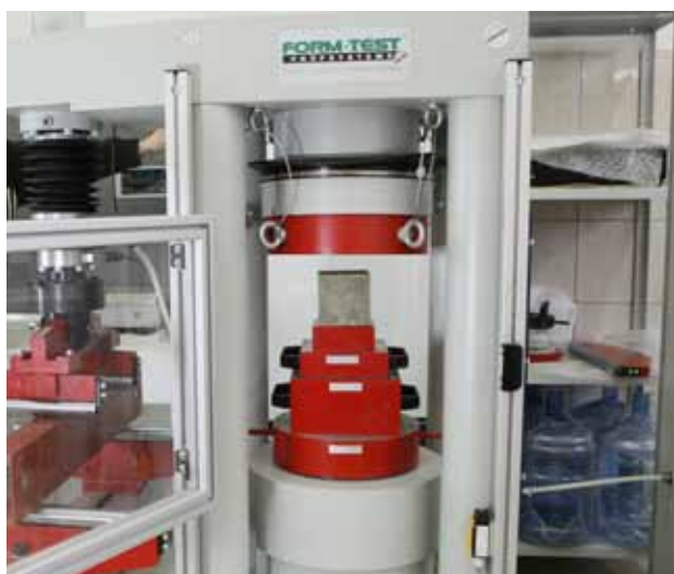
Испытание по определению прочности бетона
