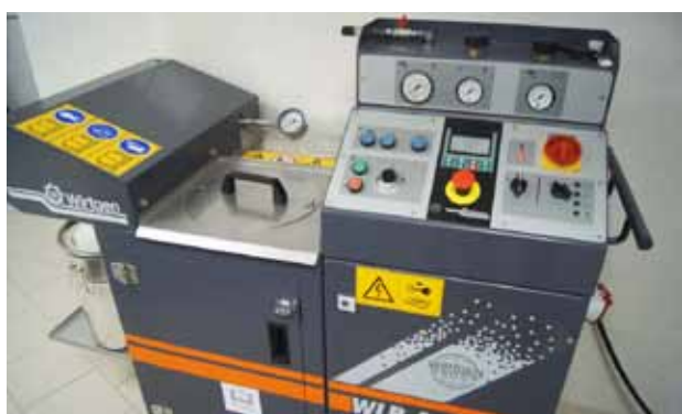
Лабораторная установка для вспенивания битума Wirtgen WLB 10S
