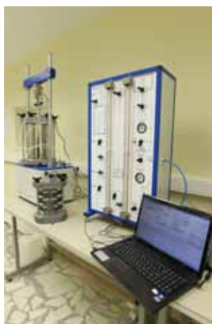
Комплект оборудования для испытаний образцов грунта в условиях трехосного сжатия вертикальной нагрузкой
