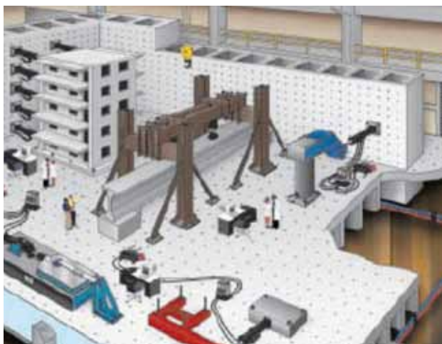
Универсальный реконфигурируемый стенд для испытаний крупногабаритных конструкций на статические и динамические нагрузки (5000 кН)
