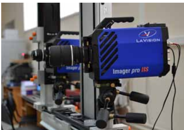
Высокоскоростная видеокамера для фотофиксации частиц в потоке и визуализации картограмм скоростных полей
