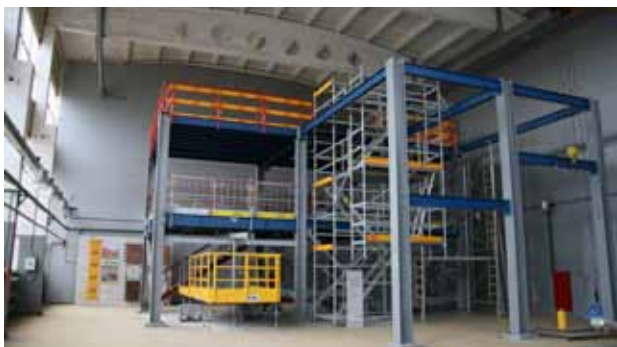
Стенд статических испытаний выносных площадок и стенд испытаний средств индивидуальной защиты при работе на высоте
