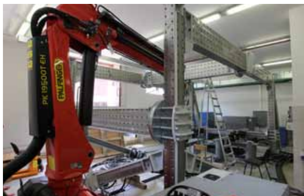
Реконфигурируемый стенд для испытаний строительных конструкций (1500 кН)
