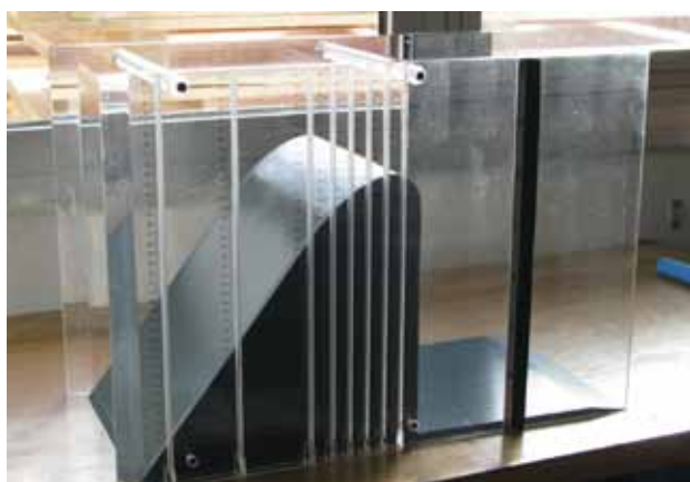
Водослив практического профиля
