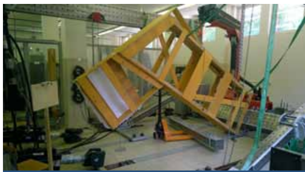
Испытание Г-образного узла радиальной балки шатра Ротонды объекта культурного наследия «Собор Воскресения Господня с подземной церковью Константина и Елены»
