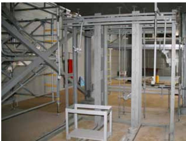
Стенд статических испытаний навесных фасадных систем
