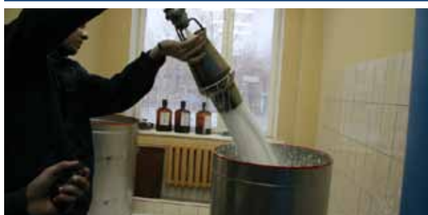
Установка для определения устойчивости и кратности пены низкой, средней и высокой кратностей
