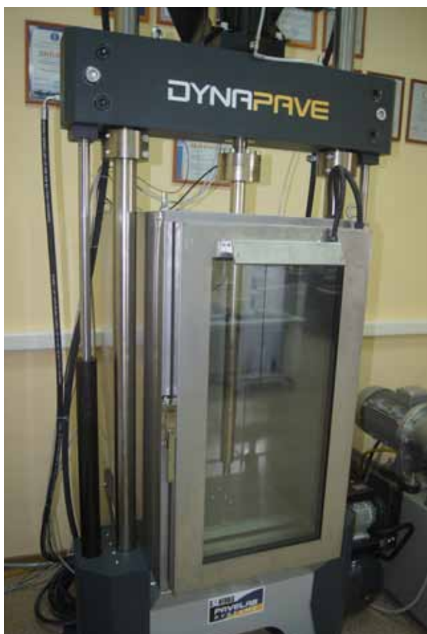
Сервогидравлическая система для динамических испытаний асфальтобетонов Dynarave 130
