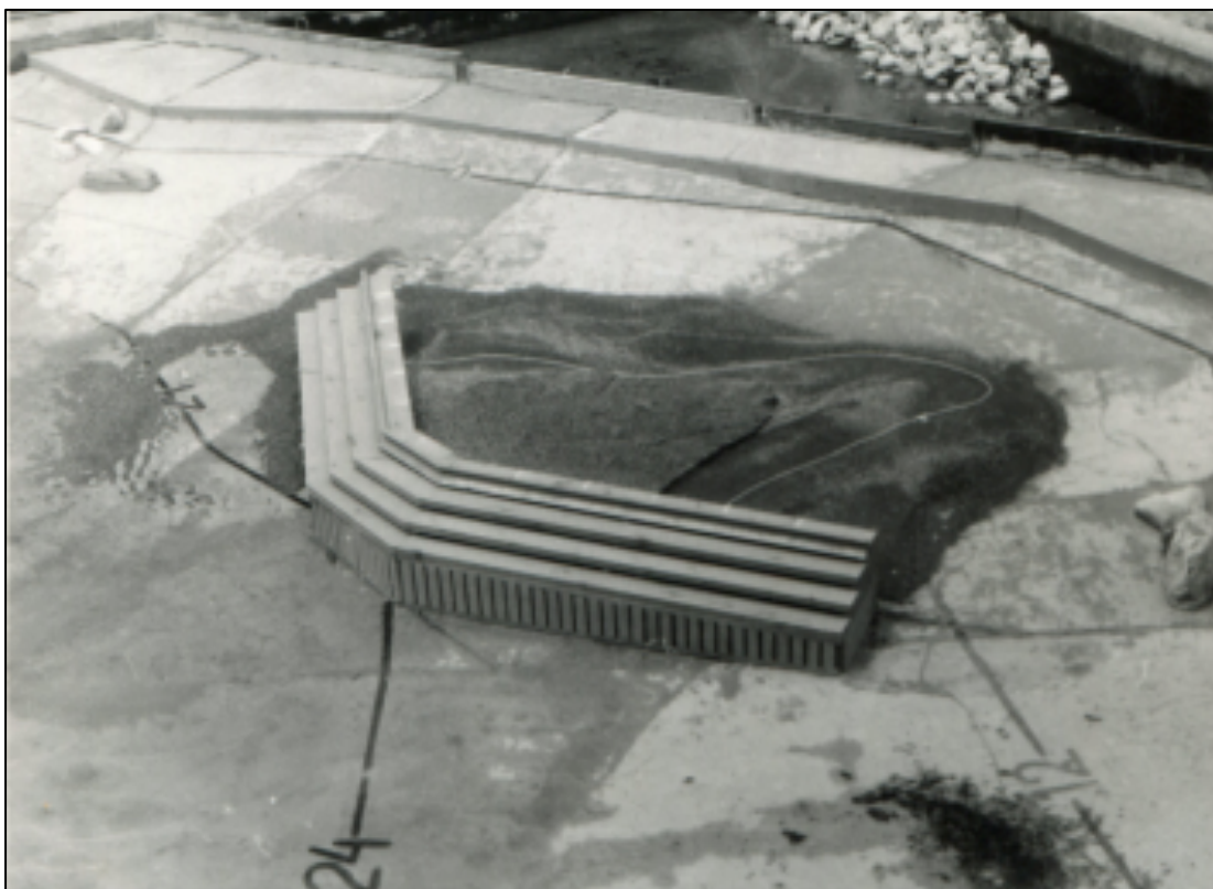
Рисунок 1.24 – Модель искусственного пляжа под защитой оградительных сооружений в волновом бассейне [53]:
