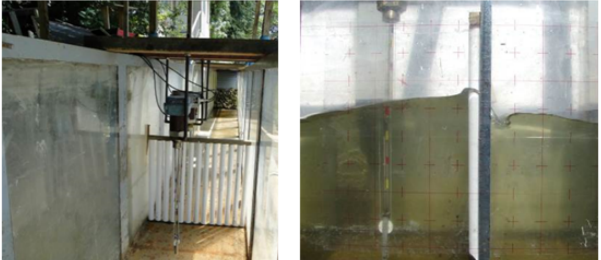
Рисунок 3.3 – Испытательное оборудование, установленное в волновом лотке. Сквозность стены в опыте – 0,3
