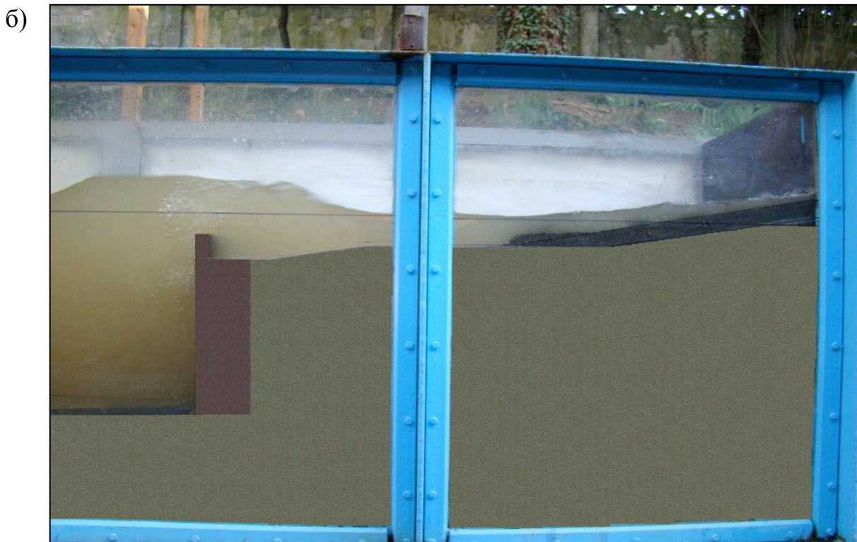
Рисунок 1.22 – Комбинированное сооружение, предложенное для удержания галечного пляжа, образованного на вновь созданной искусственной территории [51]:
