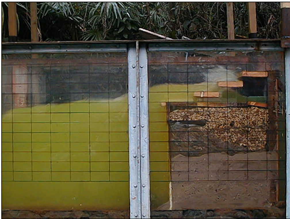
Рисунок 3.2 – Откосно-ступенчатый волногаситель (вариант №6), проект «Острова Югра» [113]
