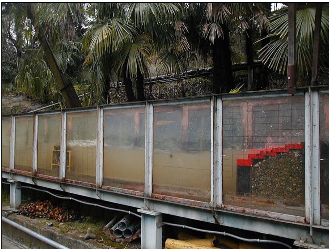
Рисунок 1.21 – Взаимодействие расчетных волн с сооружениями проектируемой марины «Хомар»
