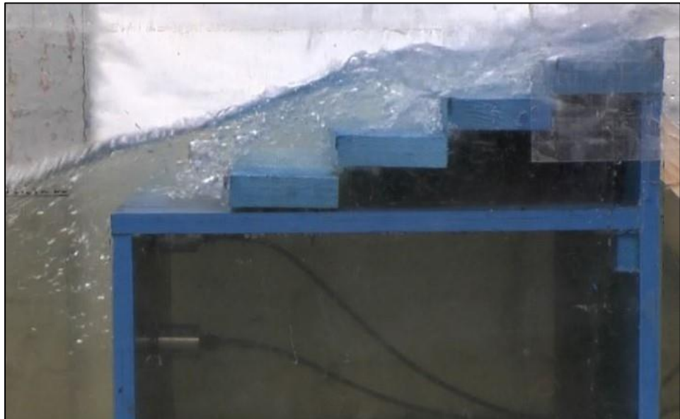
Рисунок 4.19 – Серия №3. Опыт №22. Вид модели во время опыта: а) откат волны; б) подход волны; в) накат волны
