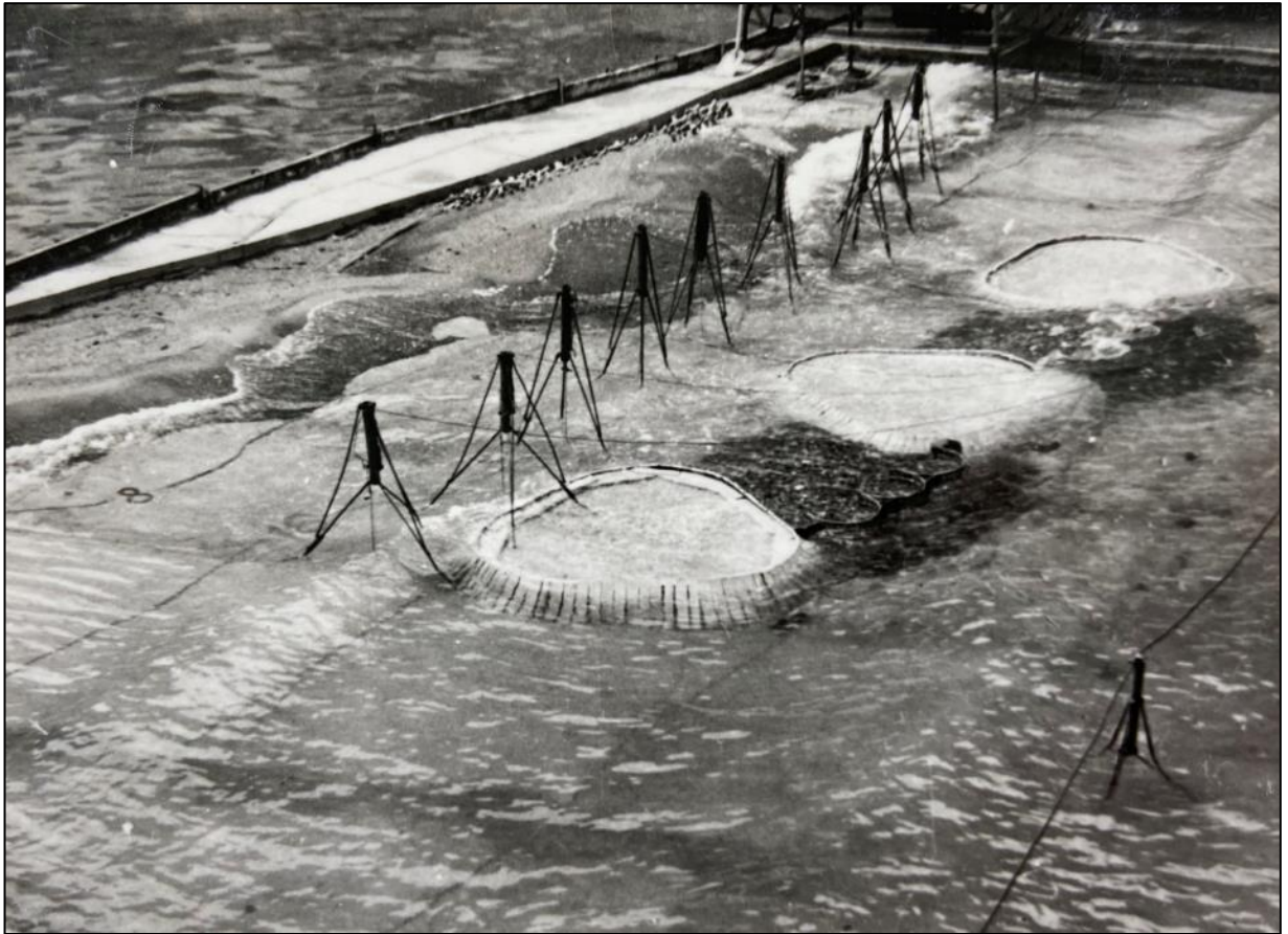
Рисунок 1.12 – Пространственная модель сооружений в волновом бассейне по рекомендуемому варианту конструкции (опыт №3)
