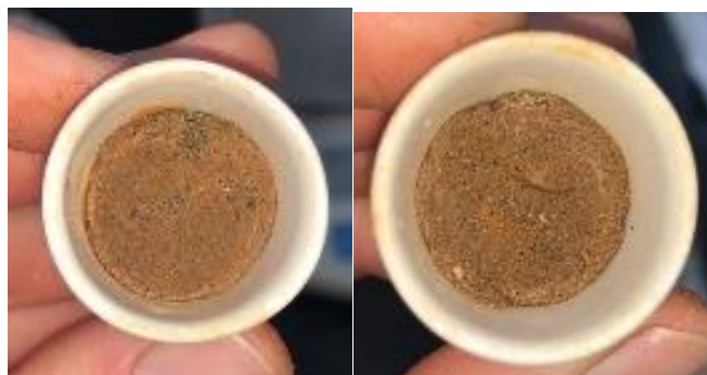
Рисунок 2. Образец № 8 до и после сгорания органики.
