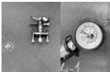
Рис. 4. Проведение испытания на отрыв мембраны
