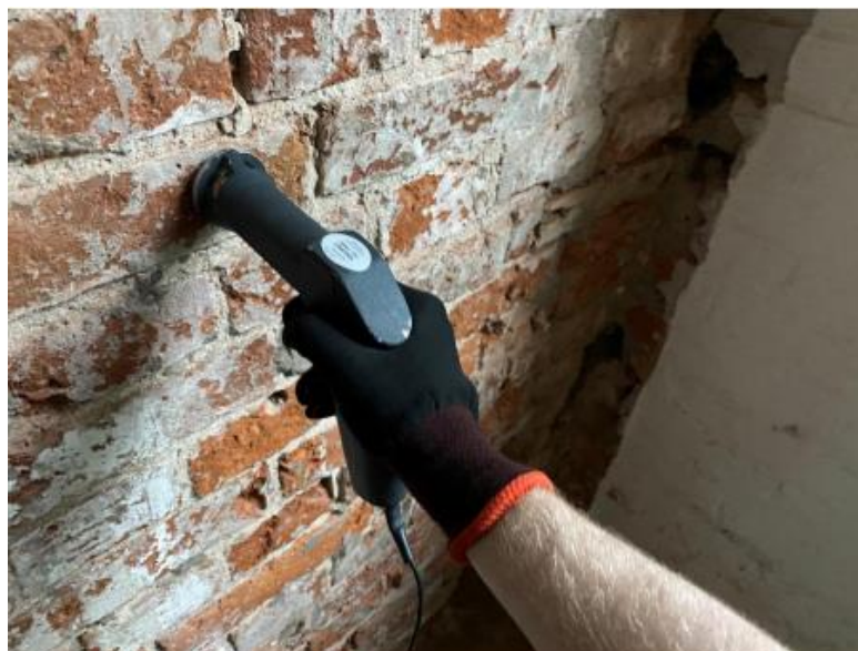
Рис. 5. Измерение прочностных характеристик кирпича керамического полнотелого кладки несущих стен обследуемого здания
