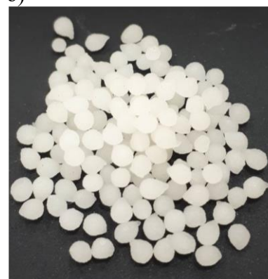
Рис. 1. Схема инкапсулирования модификатора (а) и вид капсул (б)
