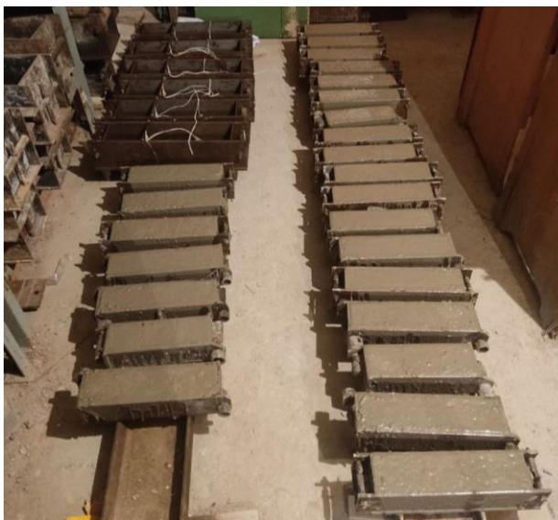
Рис. 3. Изготовление образцов призм для проведения испытаний по предлагаемой методике
