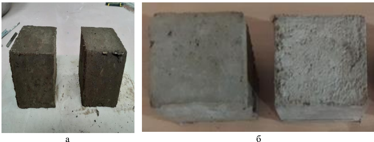
Рис. 3. Образцы арболита: а – после формования; б – после твердения
