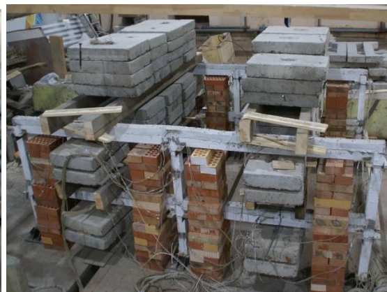
Рис. 1. Экспериментальная рама: а – схема армирования сборной части балок; б – узел сопряжения ригеля с колонной на 1-ом этапе; в – узел сопряжения ригеля с колонной на 2-ом этапе; г – конструктивная схема на 1-ом этапе; д – конструктивная схема на 2-ом этапе; е – фото рам на 1-ом этапе; ж – фото рам на 2-ом этапе
