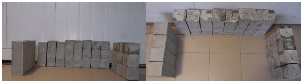
Рис. 2. Образцы для испытания прочности сцепления слоев
