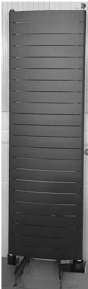
Рисунок 3. Отопительный прибор «Convex-500», установленный в изотермической камере испытательного стенда для определения номинального теплового потока
