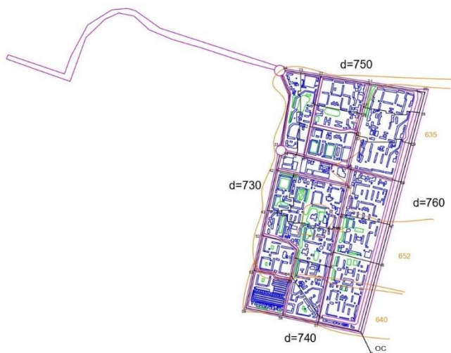
Рисунок 1. Сеть водоотведения рассматриваемого участка города Ставрополь.
