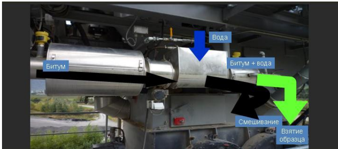
Рисунок 1. Механическое вспенивание битума пеногенератором AMMANN
