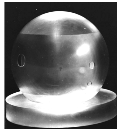
Фото модели оболочки. Модель в стадии склейки. Подкрепляющие накладки в зоне отверстий не приклеены
